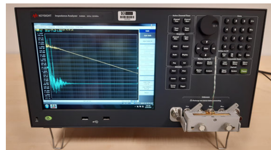
(b) Impedanzmessung mit einem Impedanzanalysator E4990A von Keysight
