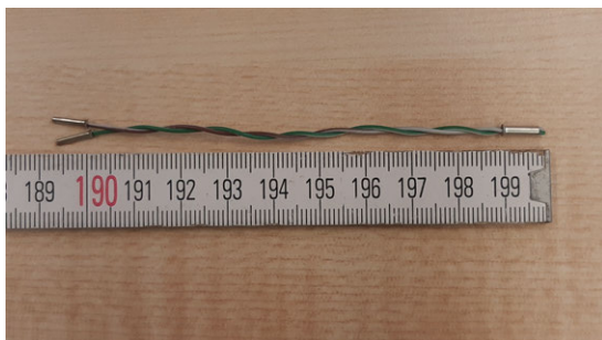
(a) 10 cm lange leerlaufende Zweidrahtleitung
