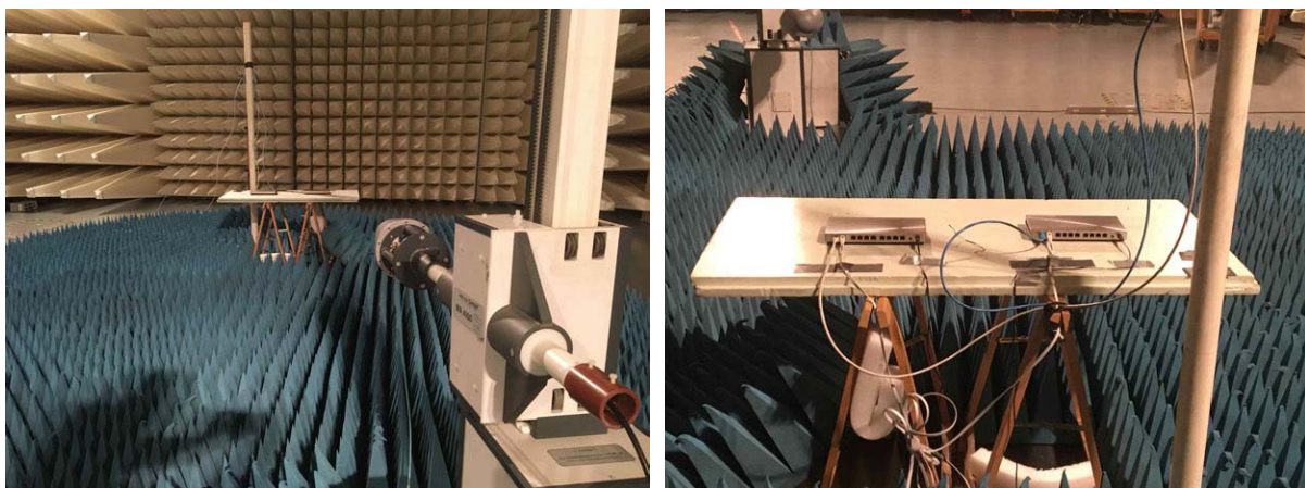
Abbildung 3.27: Messanordnung zur Untersuchung der gestrahlten Störaussendung eines 10GBase-Ethernet-Netzwerkes in der Absorberhalle
