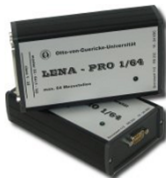
Bild 36: Einzelzellspannungsüberwachung „LENA Pro 1/64“
