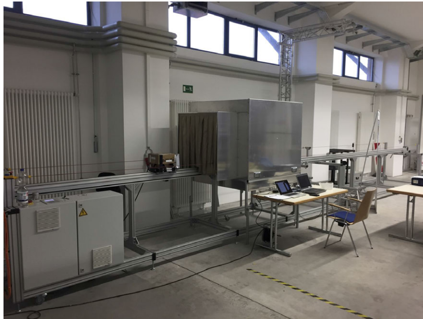
Abbildung 3.26: Tunnelgate und Linearförderer zur Optimierung der Lese- und Erkennungsrate von RFID-Tags
